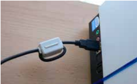
Klappkern auf dem USB-Kabel am Computer
